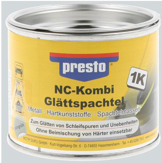
presto Nitro-Kombi-Glättspachtel ist ein einkomponentiger, lufttrocknender Glättspachtel zum dünnen Abziehen vorgespachtelter Flächen, sowie zur Egalisierung verbliebener Schleifspuren und Unebenheiten. Die porenfreie, glatte Oberfläche bildet nach sehr feinem Nassschliff die ideale Voraussetzung für eine anschließende Grundierung und Lackierung. Kann auf vielen Untergründen angewendet werden, z.B. auf Metall, Hartkunststoffen und allen Spachtelmassen.
